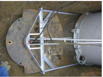
Abbildung 05: Entnahme der Lysimeterzylinder im Keuper durch UGT Münchenberg im Zeitraum vom 26.10. bis zum 09.11.2004 (Foto: UGT Münchenberg)
